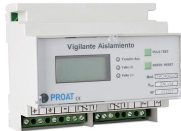
FACV es un vigilante de aislamiento para instalaciones de corriente alterna (CA) aislados de tierra, preparado tanto para sistemas monofásicos como trifásicos. Dispone de pantalla LCD que permite monitorizar en todo momento el nivel de aislamiento de la instalación. Existen modelos para 230, 440 y 750 VAC.
