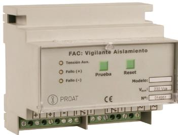
FAC1X es un vigilante de aislamiento autoalimentado y con alarma sonora, para instalaciones de corriente continua aisladas de tierra como barcos y embarcaciones deportivas. Detecta los fallos de aislamiento a tierra de los polos (+) o (-) y en caso de producirse un fallo el FAC1X activa un contacto de salida y una alarma sonora de alerta. Existen modelos para 12, 24, 48, 120 VDC.
